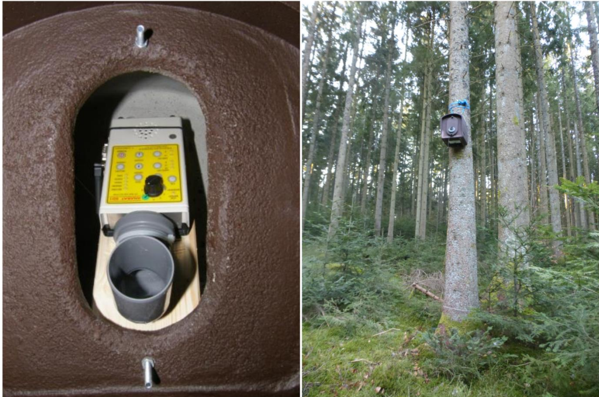
Abb. 3: Detailansicht des Aufnahmesystems, installiert in einer Dohlennisthöhle, und der Anbringung an einem Baum (hier am Anabat-Standort 2).
